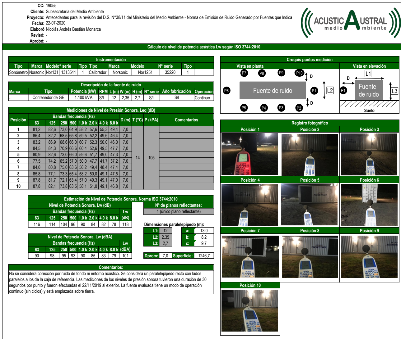
Figura N°30: Ejemplos de ficha de medición para obtención de potencia sonora según ISO 3744:2011.
