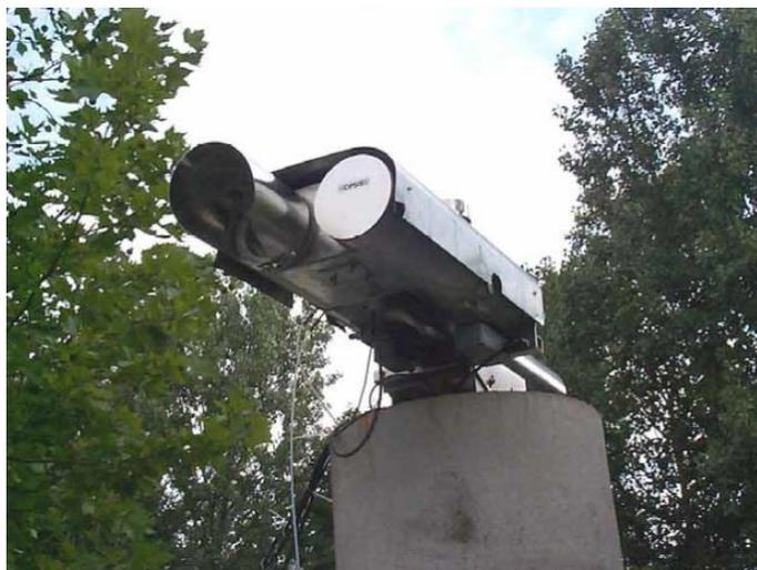
*Figura 32: Vista exterior del receptor con sistema FC 150 integrado.*
