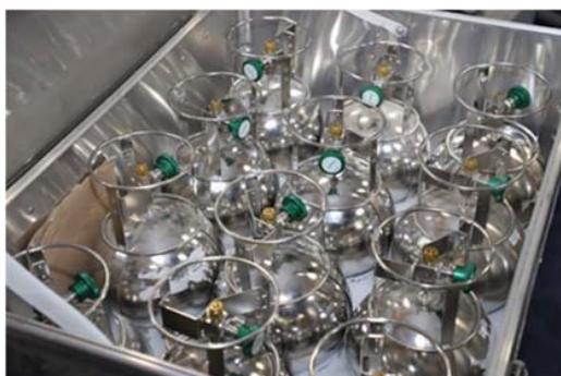
Figura 15: Muestreadores canisters utilizados en las campañas de medición.
