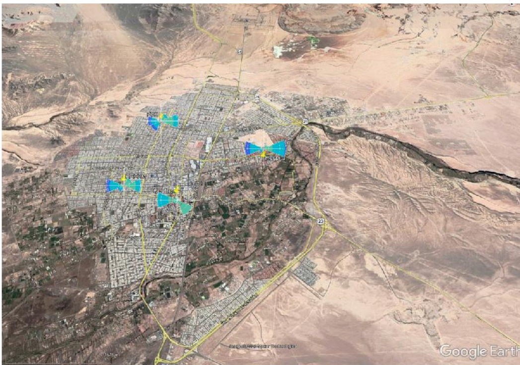
Figura 2. Rosas de viento de las estaciones de monitoreo de calidad de aire seleccionadas que representan los porcentajes de distribución de la dirección del viento entre los diferentes sectores. Los sectores de viento predominantes son el este y el oeste.
