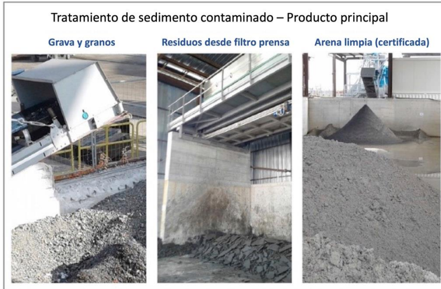
Figura 16 – Principales insumos y productos asociados al lavado de sedimentos por la planta de Trevi SpA Fuente: Sitio web de la Central Dredging Association 11
