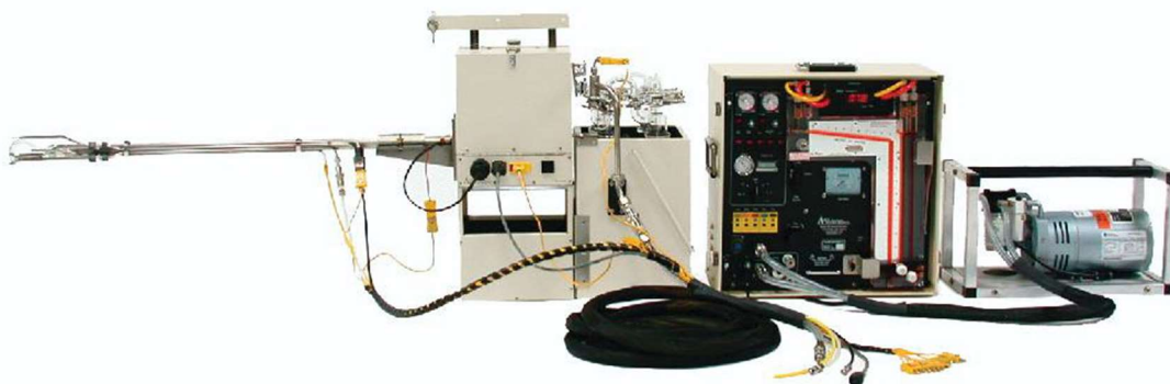
Ejemplo de equipamiento e instalación para muestreo isocinético en Chimenea
