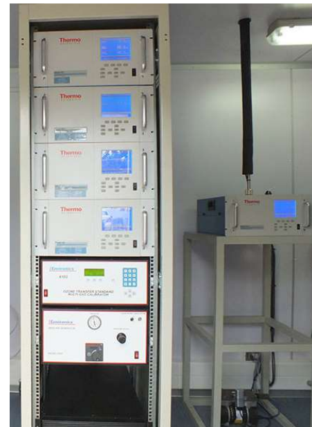
Rack con analizadores continuos de gases y monitor continuo de MP 10
